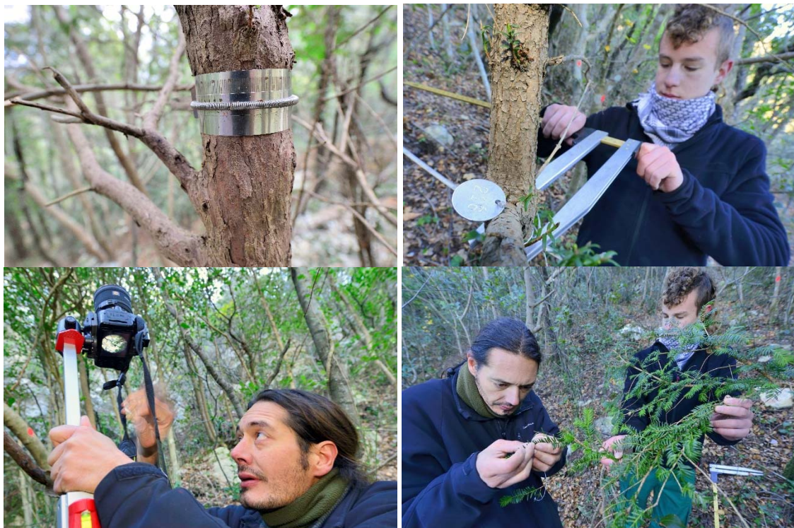
Figura 2. Estaciones de seguimiento. Dendrómetro y lectora con forcípula, fotografía hemisférica del dosel, medida del crecimiento lateral y toma de muestras para isótopos. En el muestreo han participado alumnos en prácticas de las Escuelas de capacitación Agraria del Solsonès y de Mas Bové y el Instituto de Horticultura y Jardinería de Reus, la Universidad de Vic y la Universidad de Lleida y la Universidad Autónoma de Barcelona.
